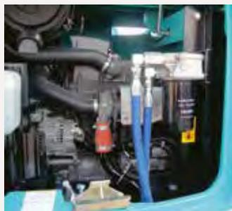
O novo motor é um motor com injetores-bomba (PFR), de elevada confiabilidade. Inclui um EGR resfriado, que reduz a temperatura do ar de escapamento misturado com a admissão, para alcançar uma redução significativa em termos de emissões, tanto de partículas (PM) como de gases (NOx) e, ao mesmo tempo, melhora sua entrega de potência.
