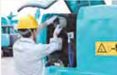
Todos os componentes que exigem manutenção regular estão localizados para facilitar o acesso. O capô, com novo design, abre amplamente e em um nível mais baixo.
