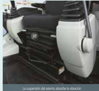
La suspensión del asiento absorbe la vibración
