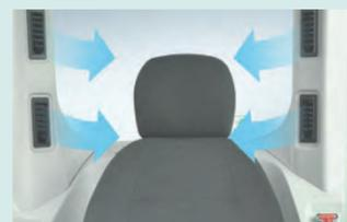
O ar-condicionado maior possui saídas nas colunas traseiras que ventilam atrás e as laterais direita e esquerda do assento do operador. Elas podem ser ajustadas para liberar um fluxo direto de ar frio/quente sobre o operador, proporcionando um ambiente de operação mais confortável.
