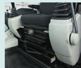
A suspensão do assento absorve vibração
