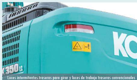
Luces intermitentes traseras para girar y luces de trabajo traseras convencionales
