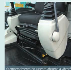
O amortecimento do assento absorve a vibração
