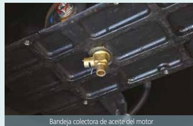
Bandeja colectora de aceite del motor
