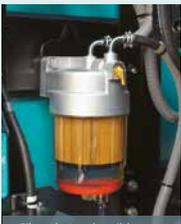
Filtro de combustible con separador de agua integrado
