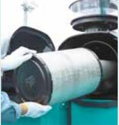
**Filtro de aire con cubierta de malla de metal**
