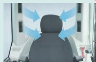
O ar-condicionado maior possui saídas nas colunas traseiras que ventitam atrás e as laterais direita e esquerda do assento do operador. Elas podem ser ajustadas para liberar um fluxo direto de ar frio/quente sobre o operador, proporcionando um ambiente de operação mais confortável.
