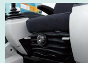
Suspensão do assento absorve vibração
