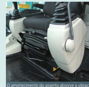
O amortecimento do assento absorve a vibração
