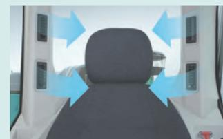
O ar condicionado de grande capacidade inclui saídas nos pilares anteriores, que fornecem ar por trás, à direita e à esquerda do assento do operador. Eles podem ser ajustados para colocar um fluxo direto de ar quente/frio na direção do operador, que representa um ambiente de operação mais confortável.
