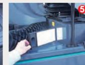
Filtro de ar condicionado pode ser facilmente removido para limpeza, sem ferramentas.
