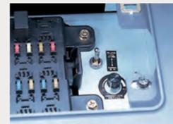
Se ocorrer um problema no sistema de controle ITCS, ainda assim a máquina pode ser operada através do sistema de aceleração de emergência. O modo de escavação muda automaticamente para um sistema de escavação de emergência e pode continuar temporariamente até que um técnico venha reparar o sistema primário.
