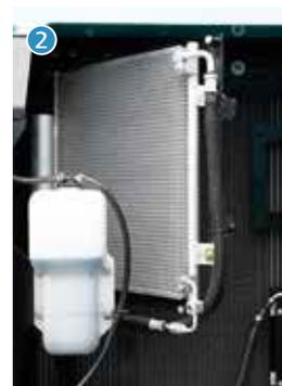
Condensador del aire acondicionado que puede abrirse
