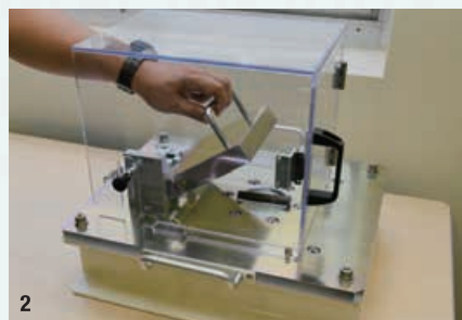
1. 林業機械をはじめ、掘削などさまざまな現場に即した建機が揃えられるのもメーカーならではの強み 2. 危険体感教育のための機器。上／感電体感、下／重量物挟まれ体感
