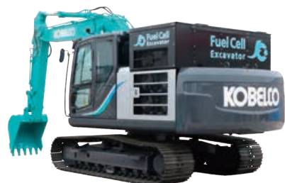
現場稼働による実証を進める水素燃料電池ショベル
