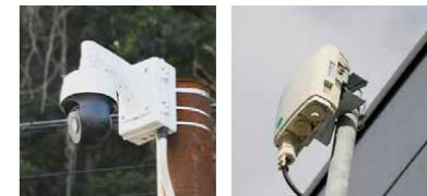
屋内のコックピットと屋外の重機、カメラなどをミリ波通信で接続。常時最新の状況を送受信することで遠隔操作を支える
