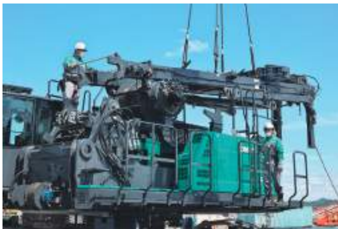
独自の設計で、ガントリの取り付け・取り外しをスムーズにした「ガントリックイックセット」
