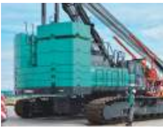
位置合わせしやすいカウンタウエイトは、グループごとに形状を共通化。輸送性・組立性に配慮した設計を追求
