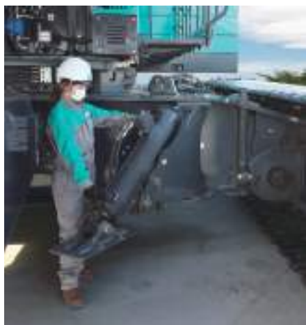
トランスリフタの跳ね上げも軽く、一人で簡単に実行。またフロートを付けたままでの輸送が可能
