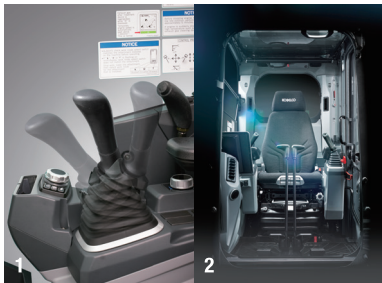
1.人間の自然な動きに対応した操作しやすいレバー、スイッチ配置などにより、キャブに圧倒的な快適性をもたらした。2.乗り心地の良い座席シート。オプションでドイツのグラマー社製のエアサスペンションシートも用意
