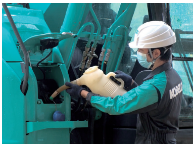
新型機ではメンテナンス性も重視し、機械に上がることなく、地上から行えるメンテナンス項目を増やした。NOx浄化用の尿素水タンクを旧型機に比べてより低い位置に設置したのもそのためである
