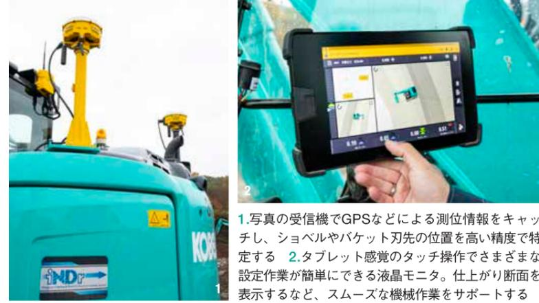
1.写真の受信機でGPSなどによる測位情報をキャッチし、ショベルやバケット刃先の位置を高い精度で特定する 2.タブレット感覚のタッチ操作でさまざまな設定作業が簡単にできる液晶モニタ。仕上がり断面を表示するなど、スムーズな機械作業をサポートする
