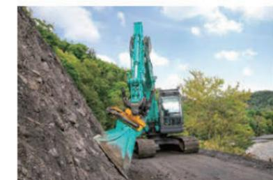
狭所や地中に配管などがある現場で活躍するチルトローテータ。2D / 3Dマシンガイダンスとチルトコントロールで施工スピード、安全性がアップする
