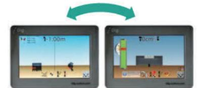
ショベルモードからドーザモードへは、モニタ上でワンタッチでの切り替えが可能
