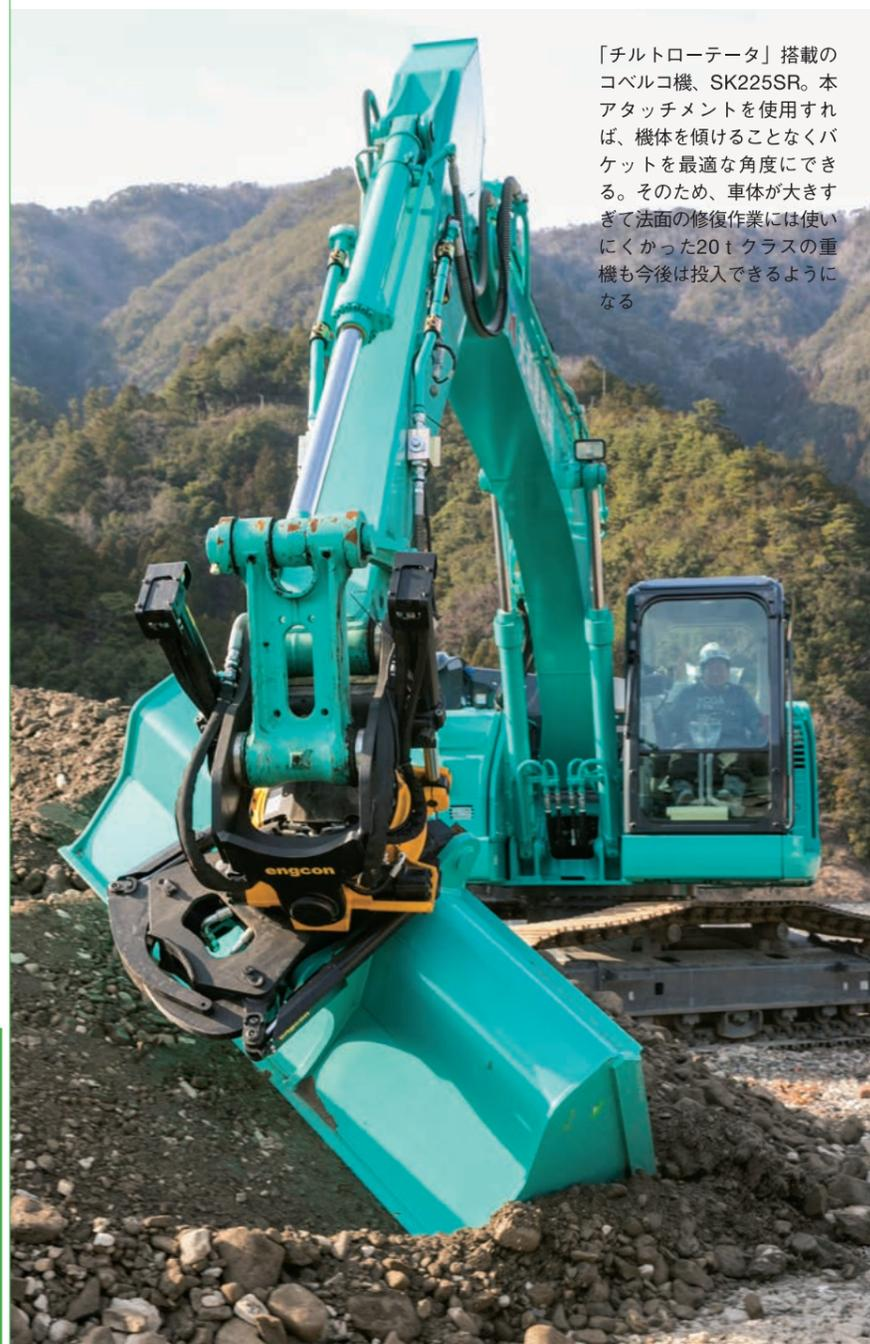
「チルトローテータ」搭載のコベルコ機、SK225SR。本アタッチメントを使用すれば、機体を傾けることなくバケットを最適な角度にできる。そのため、車体が大きすぎて法面の修復作業には使いにくかった20tクラスの重機も今後は投入できるようになる
