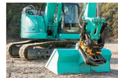
1. 「チルトローテータのレバー操作はとても簡単。オペレータなら、誰でもすぐに慣れて使えるようになるはず」と栗原さんは語る 2. キャブ内にいながらバケットの脱着が可能。作業に合わせて素早くアタッチメントを交換できる
