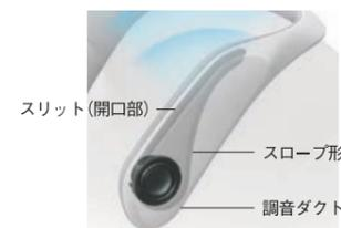
「音に包み込まれる新感覚」を実現するために、いくつものプロトタイプを製作。スピーカーに備え付けたスリット（開口部）の長さや音の方向性を整えるスローブの形状、余分な共鳴を抑える調音ダクトの配置などを調整し、現在のデザインに至った
