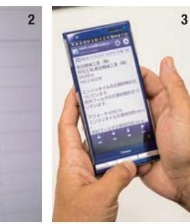
1.サービスマンは、MERiTのデータを毎朝パソコン上でチェック。定期交換時期が近い機種があれば、その日の稼働時間確認も怠らない 2.画面上では、機種ごとの稼働状況が一目瞭然。部品の定期交換時期を過ぎている機種は赤、迫っている機種は黄色のアラートが表示される 3.サービスマンや営業マンのスマホや携帯には、オイル交換時期などの担当ユーザの建機に関する情報がメールで告知されるため、外回り中でも迅速な対応を可能にしている
