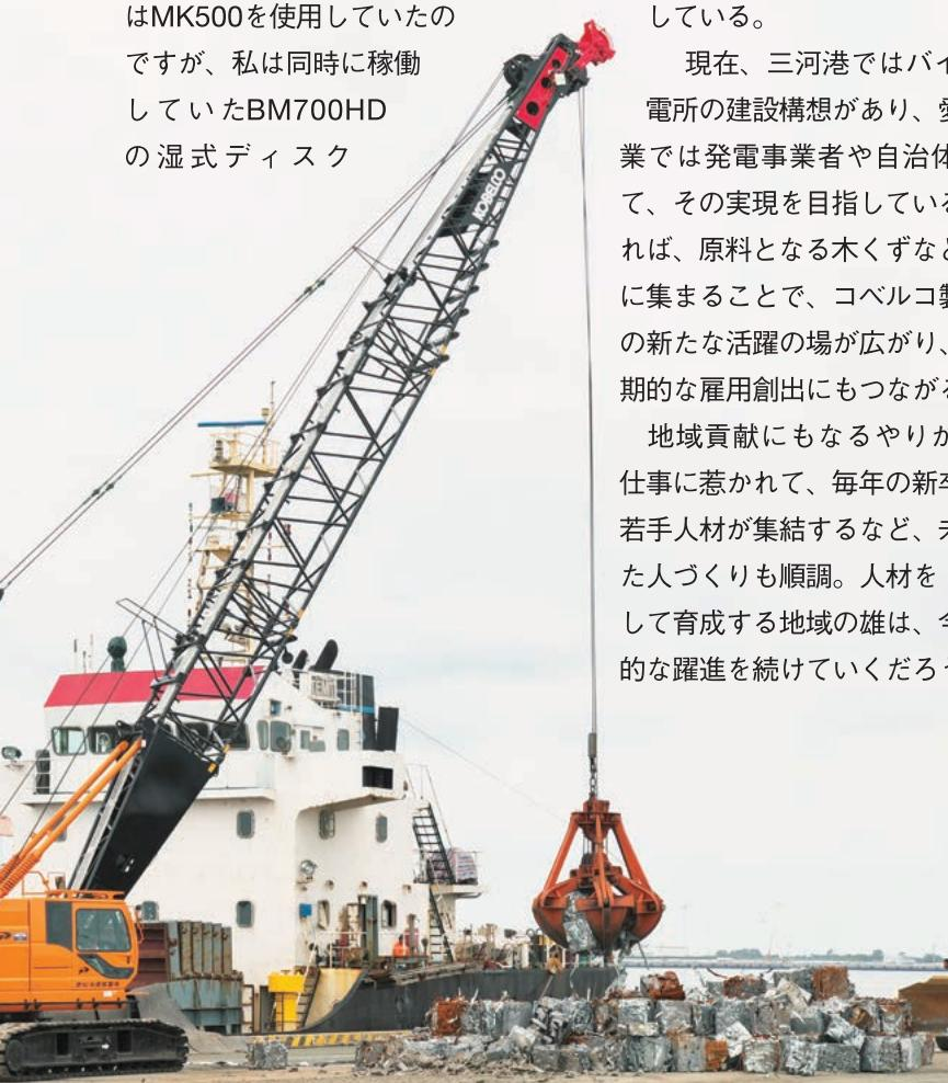
3.BM800G-2には1.8m<sup>3</sup>のバケットを装備。鉄スクラップをつかんだ後に旋回し、その勢いを利用してバケットをタイミング良く開くことで、船底の狙った場所にピンポイントで投入する。4.オペレータの小林さんと牧野さんは、バケット作業において細かなペダル操作を不要にした湿式ディスクブレーキを絶賛。ショートレバーの位置も腕や肩に力を入れずに操作できると高く評価する。5.2018年に導入したBM800G-2が稼働する現場の対岸には、前年に導入した同機の姿も
