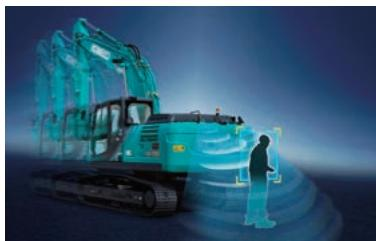
建機メーカ初の衝突軽減システム『K-EYE PRO』。現在は20tクラスのオプションだが、今後は標準化やその他のクラスへの搭載を目指している
