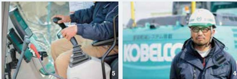
4. オペレーターの清水雅史さん。「ホルナビ+PLUS搭載機を使えば、作業効率が向上し、工期の短縮にもつながるなど、プラス面しかないですね」 5. オペレーターは、アームレバー操作のみでショベルの掘削作業におけるアクションを半自動で制御可能に 6. 岡田さんと事務の仕事を一手に仕切る齋藤京美さん
