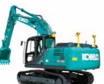
アームレバー操作だけで、設計面に沿った施工が実現。習得までに多くの経験を要する「ブーム」「アーム」「バケット」の複合操作を半自動化することで、誰でも熟練オペレータ並みの生産性と精度を実現する
