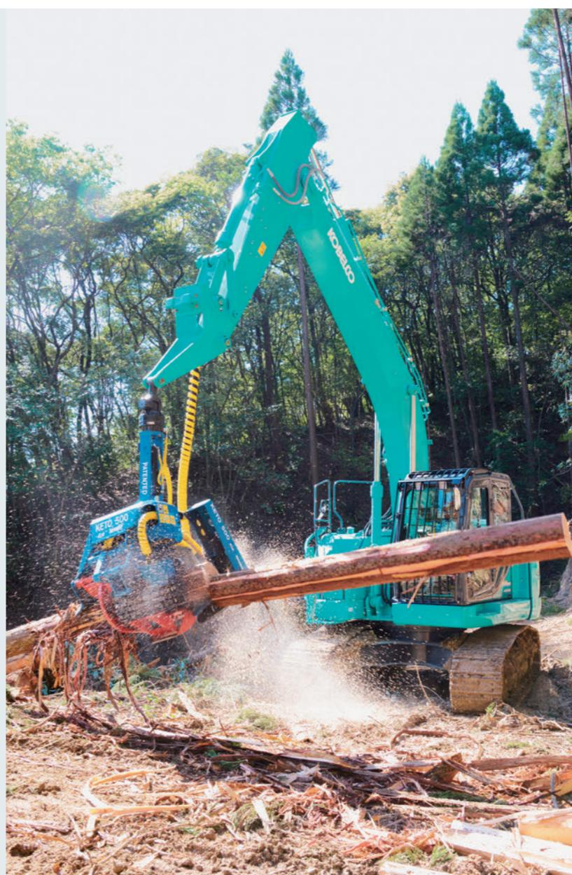
2台同時導入したSK225SRの1台には、フィンランドのKETO社製ハーベスターを装着。伐倒や枝払い、玉切り作業をパワフルにこなす
