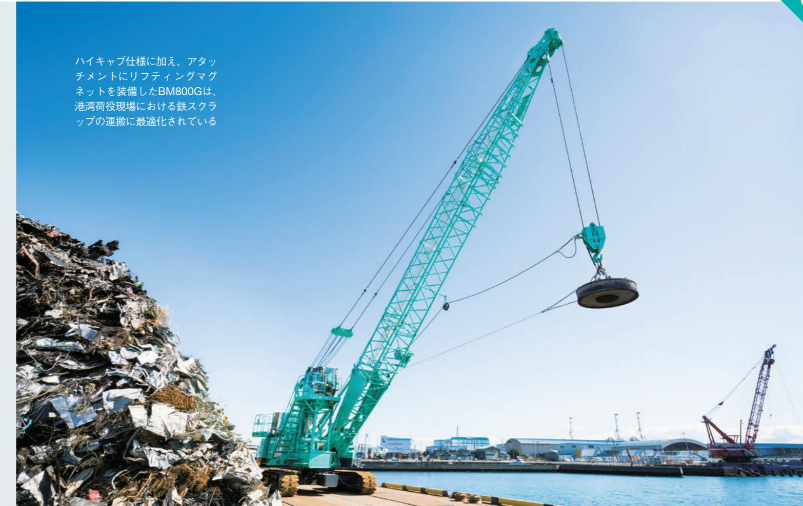
ハイキャブ仕様に加え、アタッチメントにリフティングマグネットを装備したBM800Gは、港湾荷役現場における鉄スクラップの運搬に最適化されている
