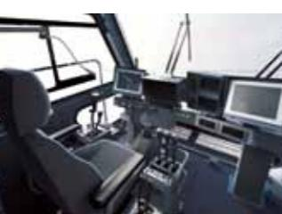
キャブの幅は1.8mにして、広い視界を確保。オペレータの快適な作業環境を実現するための設計にもこだわっている
