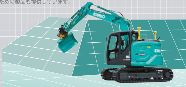
ホルナビ製品(3Dチルトマシンコントロール)
