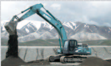
海拔4,310m地点的发动机高原试验
