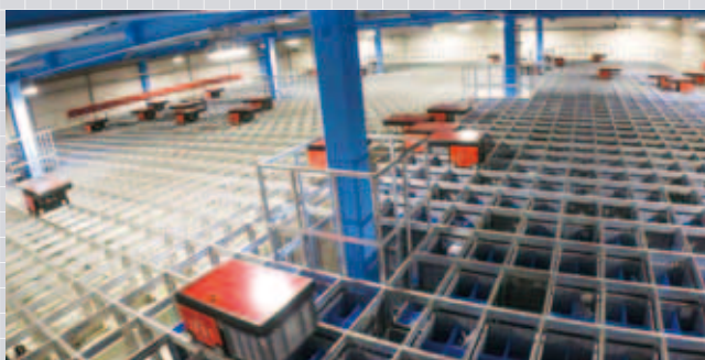
自动仓库型拣选系统(东条零件物流中心)
